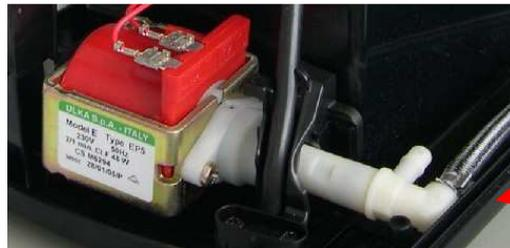
La boucle du collier Oetiker doit être orientée vers le bas pour garantir le non contact avec le socle
