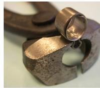
Pincer jusqu'à la mise en contact des 2 parties de la boucle du collier.
